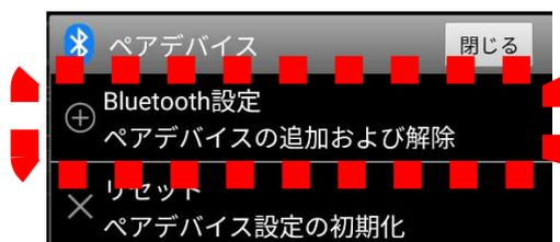
13. 「接続設定」画面にて RTK 補正データを送信する Bluetooth 機器を「ペアデバイス」に設定します。事前に対象の Bluetooth 機器の MAC アドレスを確認し、電源を ON の状態にしておいてください。「接続設定」画面の「新しいデバイスとペア設定」をタップします。
