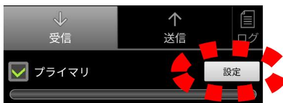
8. 「受信設定」画面の「ホスト」欄にサーバーの「IP アドレス」を入力します。「ポート」欄や「マウントポイント」欄の設定が必要な場合は適宜設定します。「OK」をタップし入力を確定します。
