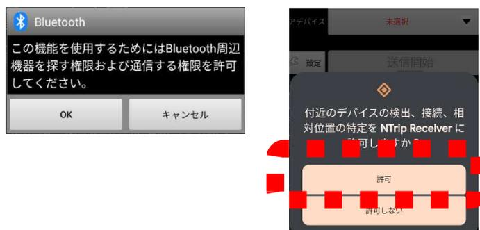
11. まだ端末の Bluetooth 機能を ON にしていない場合は、「ペアデバイス」欄の右側のボタンをタップしたときに有効 (ON) にするようにメッセージが表示されるので ON にします。
