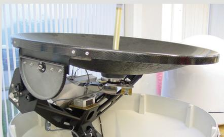
多くの移動体衛星通信アンテナが KVH の DSP-3000 を採用して高精度のポインティングとスタビライゼーションを確保しています。
