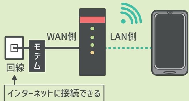
高性能版自動開閉器を使用するときにはルーターに接続し、ルーターからLAN側(ローカル)IPアドレスをもらう。遠隔操作はインターネット経由での接続なのでインターネット回線を契約したり、SIMを契約したりして、グローバルIPアドレスを提供してもらう必要がある。
