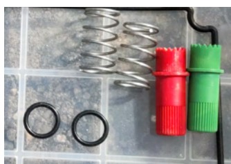
既存モータから取外して 再利用するもの ・ツマミ(赤・緑) ・バネ×2
